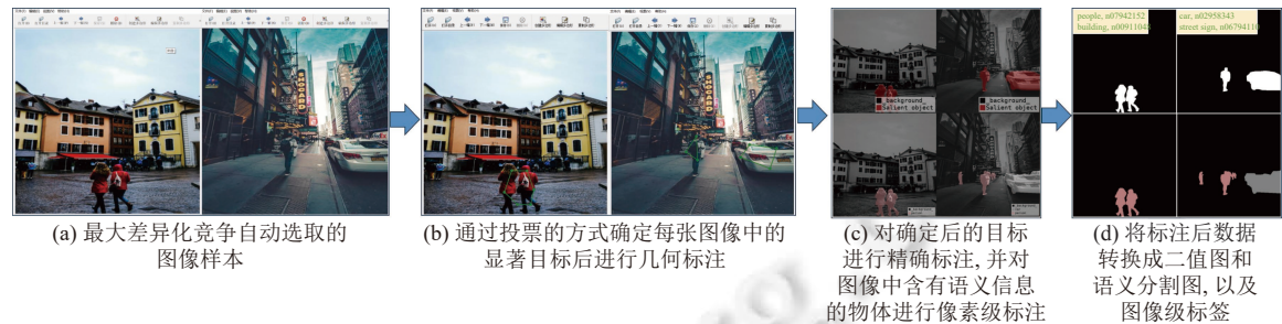
图 6 GHS-CV 区域级和像素级信息标注过程
