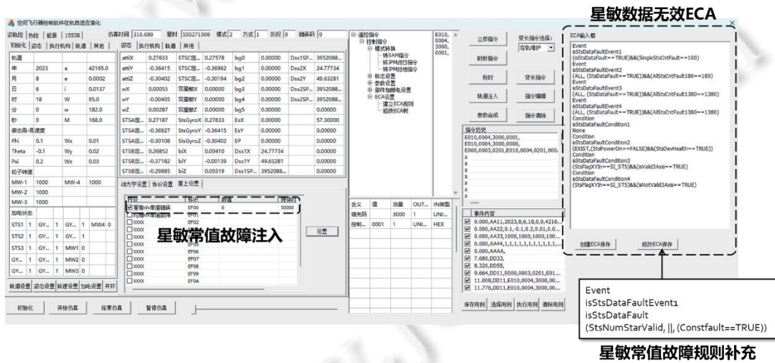
图 17 空间飞行器控制软件在轨自适应演化仿真系统界面
