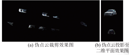
图 5 伪点云裁剪效果图及投影至二维平面效果图
