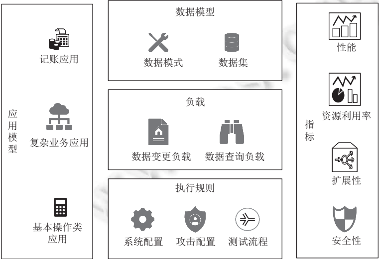
图 3 测试基准参考框架 UFBCB
