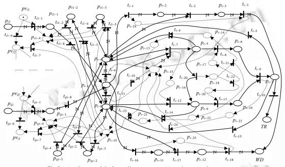
Fig. 2 A subnet model of a trading processor (i) static processing system 图 2 交易机(i)静态数据撮合子系统 Petri 网模型
