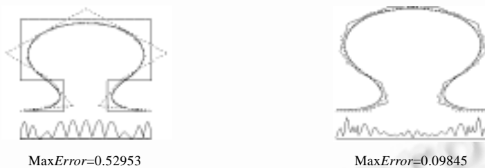
(c) New method with the weight function (d) Degree reduction of the B-spline curve after knot insertion (c) 增加权函数的新方法 (d) 经过节点插入的曲线的降阶
