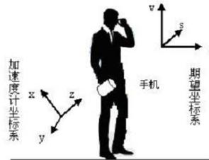
图 3 运动状态识别中的两个坐标系
