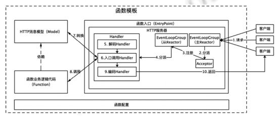
图 10 函数模板结构和运行时请求处理流程
