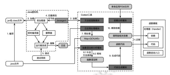
图 6 Codext 工具工作原理
