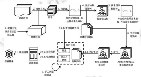
图 1 单体应用外部 API 迁移方法流程
