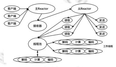
图 5 主从多线程 Reactor 模型
