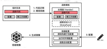
图 4 函数模板构建和容器镜像生成流程
