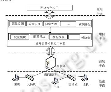
Fig.9 SDN abnormal traffic detection framework on intermediate platform 图 9 位于中间平台的 SDN 异常流量检测框架
