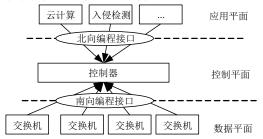
Fig.1 Basic architecture of SDN<sup>[8]</sup> 图 1 SDN 的基本架构<sup>[8]</sup>
