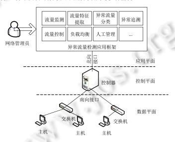
Fig.7 SDN abnormal traffic detection framework on application plane 图 7 位于应用平面的 SDN 异常流量检测框架
