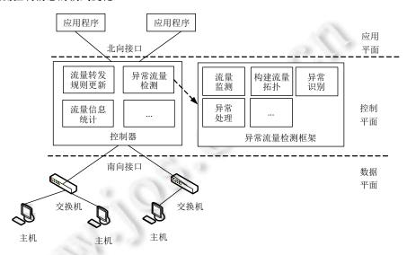
Fig.5 SDN abnormal traffic detection framework on control plane 图 5 位于控制平面的 SDN 异常流量检测框架
