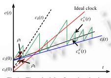
Fig.1 The principle of synchronization 图 1 同步原理
