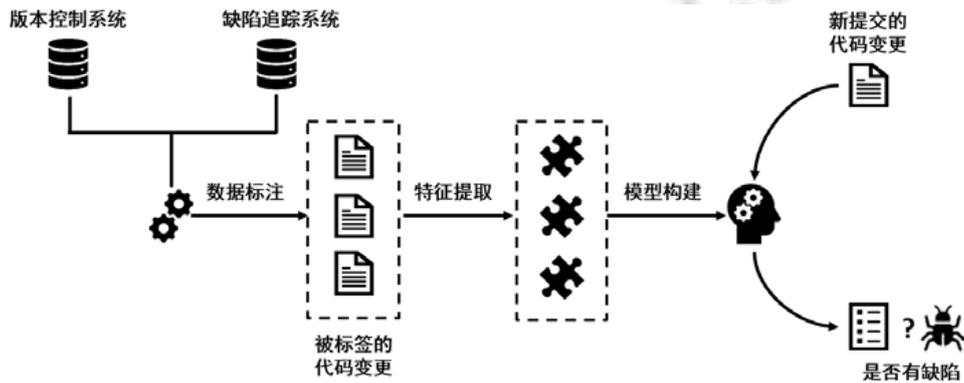
图 2 即时缺陷预测技术一般框架
